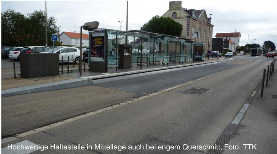
Hochwertige Haltestelle in Mittellage auch bei engem Querschnitt, Foto: TTK
